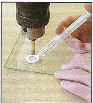
Подавать СОЖ удобно с помощью шприца. Пластиковое кольцо служит для удержания жидкости в зоне сверления.
